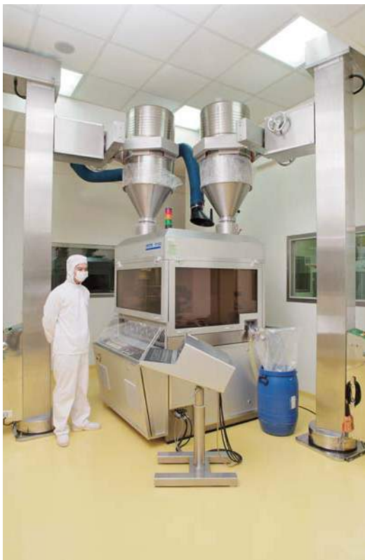
生達製藥在生產技術上不斷提升，研發新式藥劑，轉型往高值化、國際化發展。(圖為高效能打錠機)
